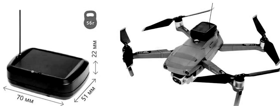
Рис. 2. Внешний вид транспондера Москит (слева); пример закрепления транспондера на БАС (справа).
