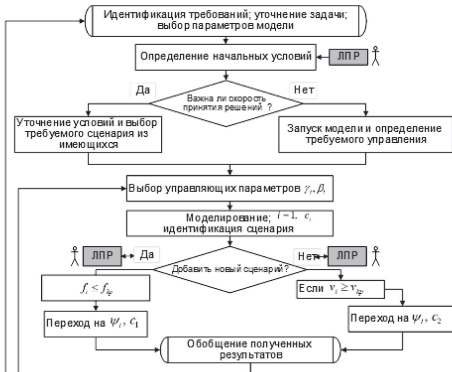
Рис. 6. Алгоритмированная схема системы управления защитой сложных технических объектов на основе типизированного сценарного подхода
