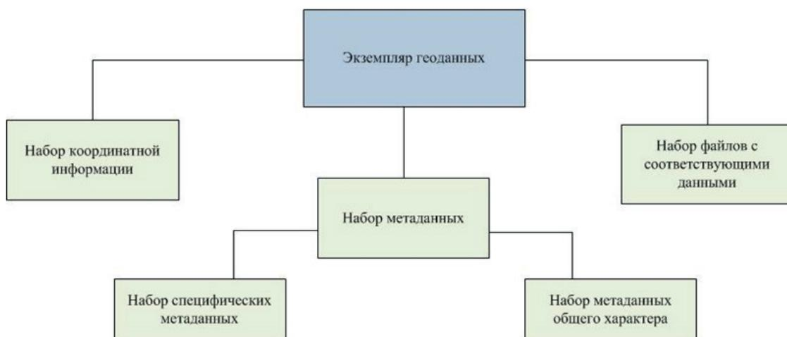
Рис. 2. Состав типового экземпляра геоданных, адаптированного для хранения в территориально-распределенной базе частных каталогов
