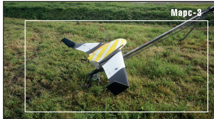
Конструкцией беспилотного летательного аппарата «Марс-3» является летающее крыло – идеальная платформа для переноса большой полезной нагрузки, обладающее высокой выносливостью.
