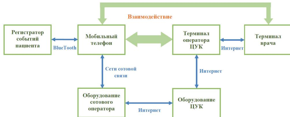
**Рис. 1.** Схема обмена данными между узлами системы удаленного контроля состояния людей с умственными ограничениями
