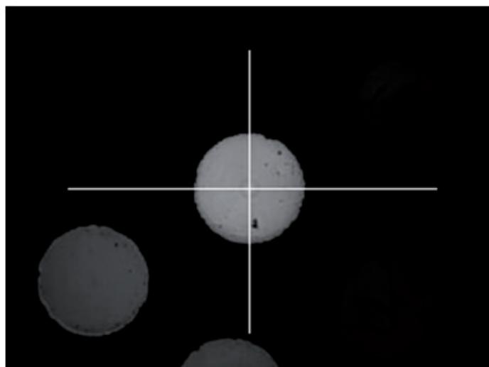
**Рис. 2.** Изображение выходного торца световода, в центре кадра – исследуемый образец оптического волокна.
