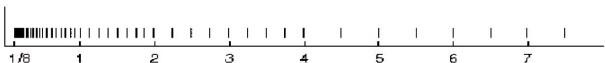
Рис. 2. Положение числовых точек на числовой оси вблизи нуля для числовой модели действительных чисел в 7-битном стандарте IEEE для чисел с плавающей точкой
