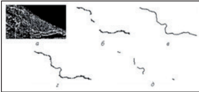
Рис. 4. Определение множеств R_i , M_i , R_i \cup M_i и M_i \setminus R_i для радиолокационного объекта: а – исходное изображение; б – R_i ; в – M_i ; г – R_i \cup M_i ; д – M_i \setminus R_i
