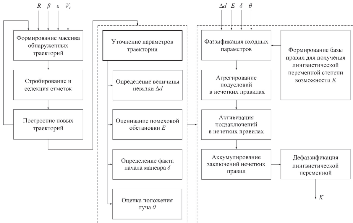
Рис. 5. Схема построения траектории сопровождаемых МЛА из состава единой группировки на основе нечеткого логического вывода
