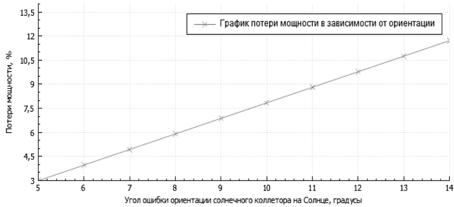
Рис. 6. График зависимости потерь мощности от ошибки ориентации солнечного коллектора
