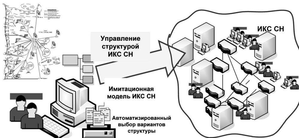
Рис. 5. Применение имитационной модели ИКС СН в контуре АСУ ИКС СН при организации управления ее структурой
