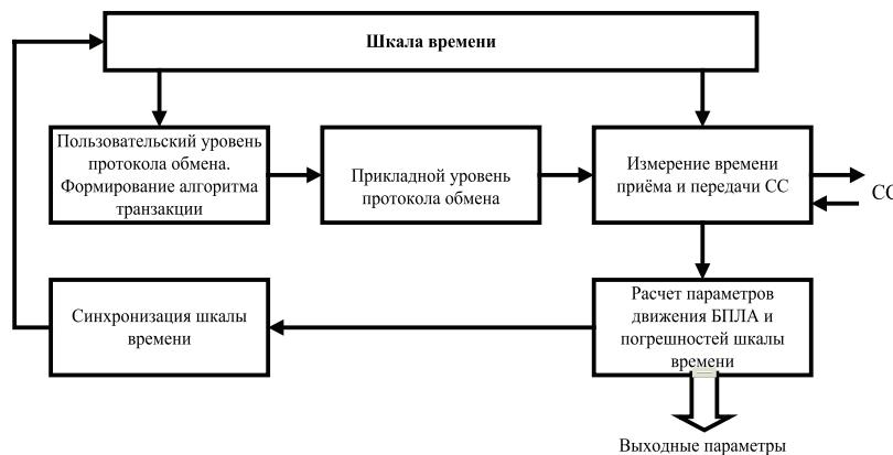
**Рис. 1.** Общая структура взаимосвязей между шкалой времени, уровнями протокола обмена, рассчитываемыми погрешностями шкалы времени и параметрами движения БПЛА
