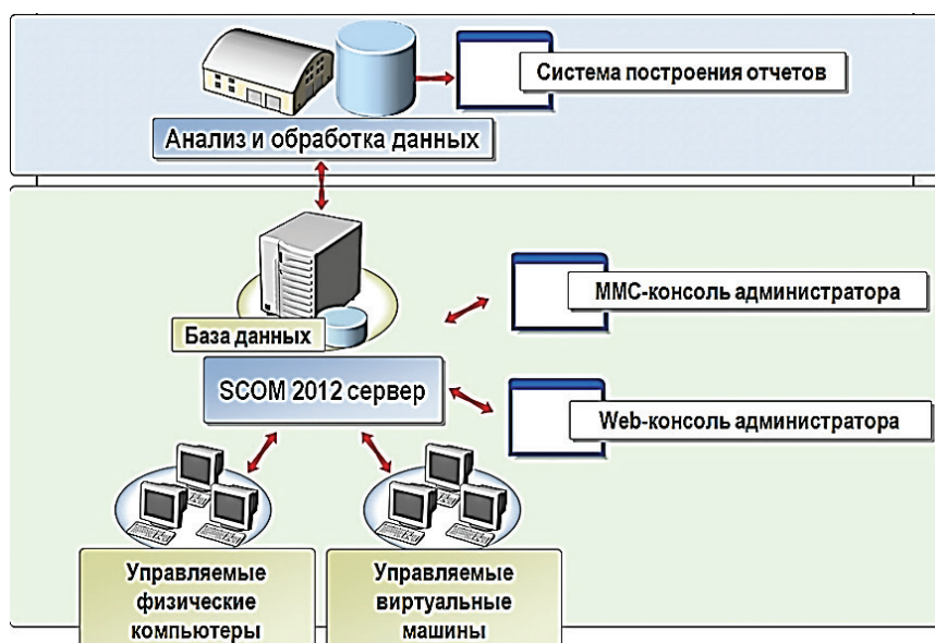
Рис. 11. Принцип работы сервера SCOM 2012
